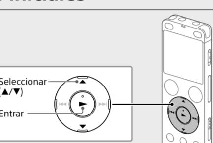
Cuando encienda la grabadora IC por primera vez, en el visor aparecerá "Configure Initial Settings". A continuación puede seleccionar el idioma del visor, ajustar el reloj, y activar/desactivar el pitido.
