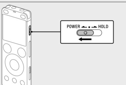
Deslice y no suelte el interruptor POWER•HOLD en el sentido de "POWER" hasta que se muestre el visor.
